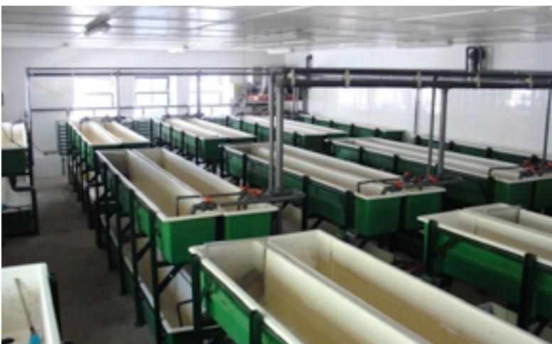
Fig. 3 - Exemplo de tanques de alevinagem em fibra de vidro
