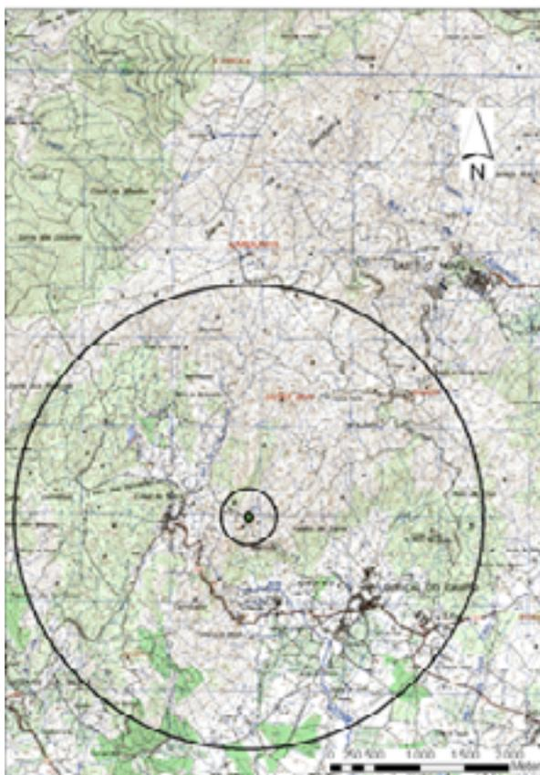
Fig. 3 – Delimitação das áreas de proteção em torno das captações pela aplicação do método do Raio Fixo - Representação das zonas de proteção imediata, intermédia e alargada.
