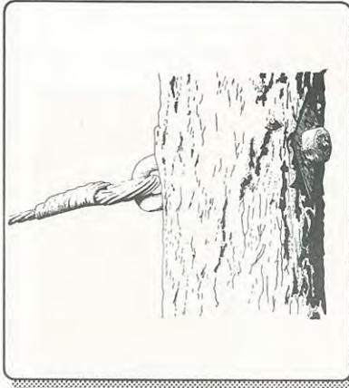
Fig. 4 - Detalhe da fixação de cabos ao tronco.
